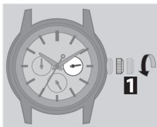
**Ruotando la corona in senso antiorario regolare la data.**
