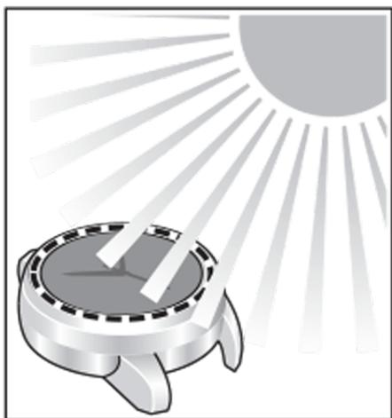
**Questo orologio funziona con una batteria che si ricarica esponendo il quadrante alla luce solare diretta o a quella di lampade fluorescenti. Dopo essersi sfilati l'orologio si suggerisce di esporre il quadrante a una luce intensa, ad esempio vicino a una finestra.**
