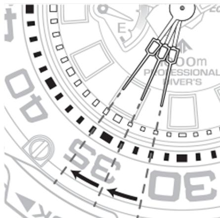
Quando la riserva di carica si riduce notevolmente la lancetta dei secondi inizia ad avanzare due passi alla volta. Tale movimento è dovuto alla funzione di avviso di carica insufficiente. Occorre perciò ricaricare completamente l'orologio.
