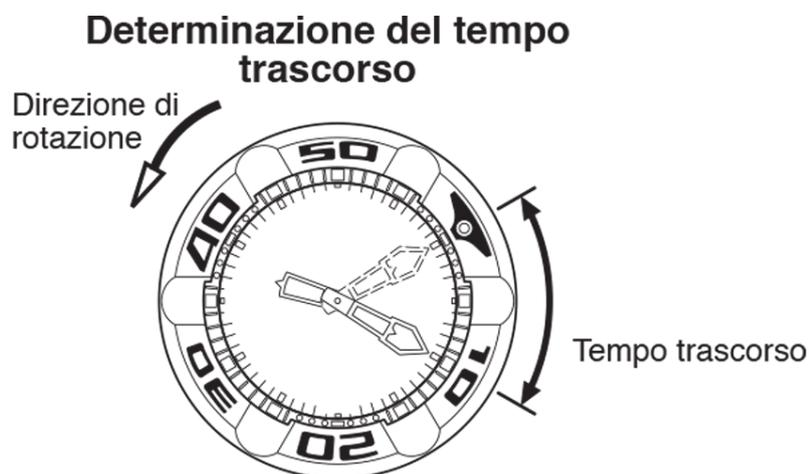
\* Allineare il simbolo ▼ presente sulla lunetta rotante con la lancetta dei minuti. Dopo che è trascorso un certo periodo di tempo, è possibile determinare il tempo trascorso leggendolo direttamente sulla scala della lunetta rotante.
